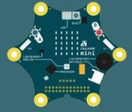
Mit dem Calliope mini lassen sich Pflanzen überwachen. Wenn die Erde zu trocken ist, wird kein Strom mehr geleitet. Dadurch können wir feststellen, dass die Pflanze getränkt werden muss. Für die Programmierung brauchst du folgende Zusatzmaterialien:
