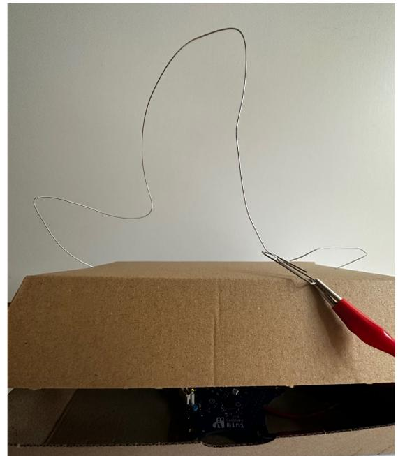
TIPP: Dein Stab muss aus Material gebaut sein, welches leitet. Die Krokodilzangen müssen korrekt angeschlossen sein. Wenn du mit dem Stab den Draht berührst, dann sollte der Stromkreislauf geschlossen sein und deshalb Musik erklingen. Nutze für die Stromversorgung die Batterien.
